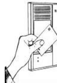
dioda i uređaj će se zvučno oglasiti i vrata će se otvoriti. Takođe, ako je pristup van podešenog vremenskog okvira korisnik neće moći otvoriti vrata. U slučaju kontaktne varijante čitača korisnik mora prisloniti ključić na površinu predviđenu za očitavanje i ako je pristup dozvoljen i u podešenom vremenskom okviru vrata će se otvoriti.
